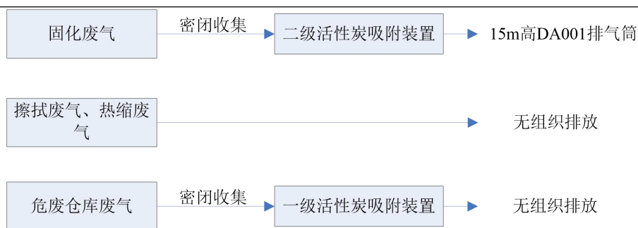
图 4-1 废气收集处理流程图
